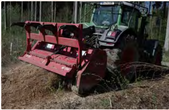
Abb. 2: Einarbeitung organischen Materials in den Oberboden durch Mulchen
