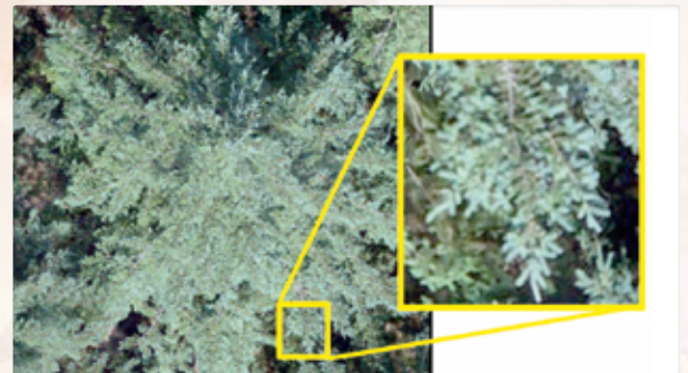
Orthophoto mit einer Bodenauflösung von 1cm
