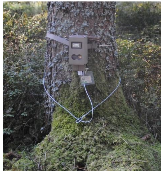
Abbildung 3.1: Die Wildkameras wurden mit Spanngurten am Baumstamm befestigte und mit Drahtschlingen sowie einem Schloss vor Diebstahl gesichert. Foto: FVA
