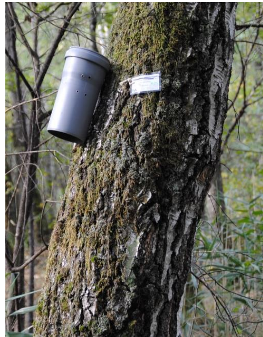
Abbildung 4.4: Die Haarfalle kann einfach mit Gartendraht an einem Baumstamm befestigt werden. Foto: FVA
