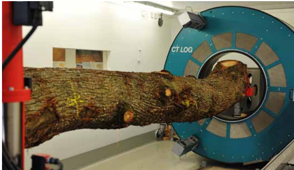
Abb. 1: Computertomograf CT.LOG an der FVA in Freiburg
