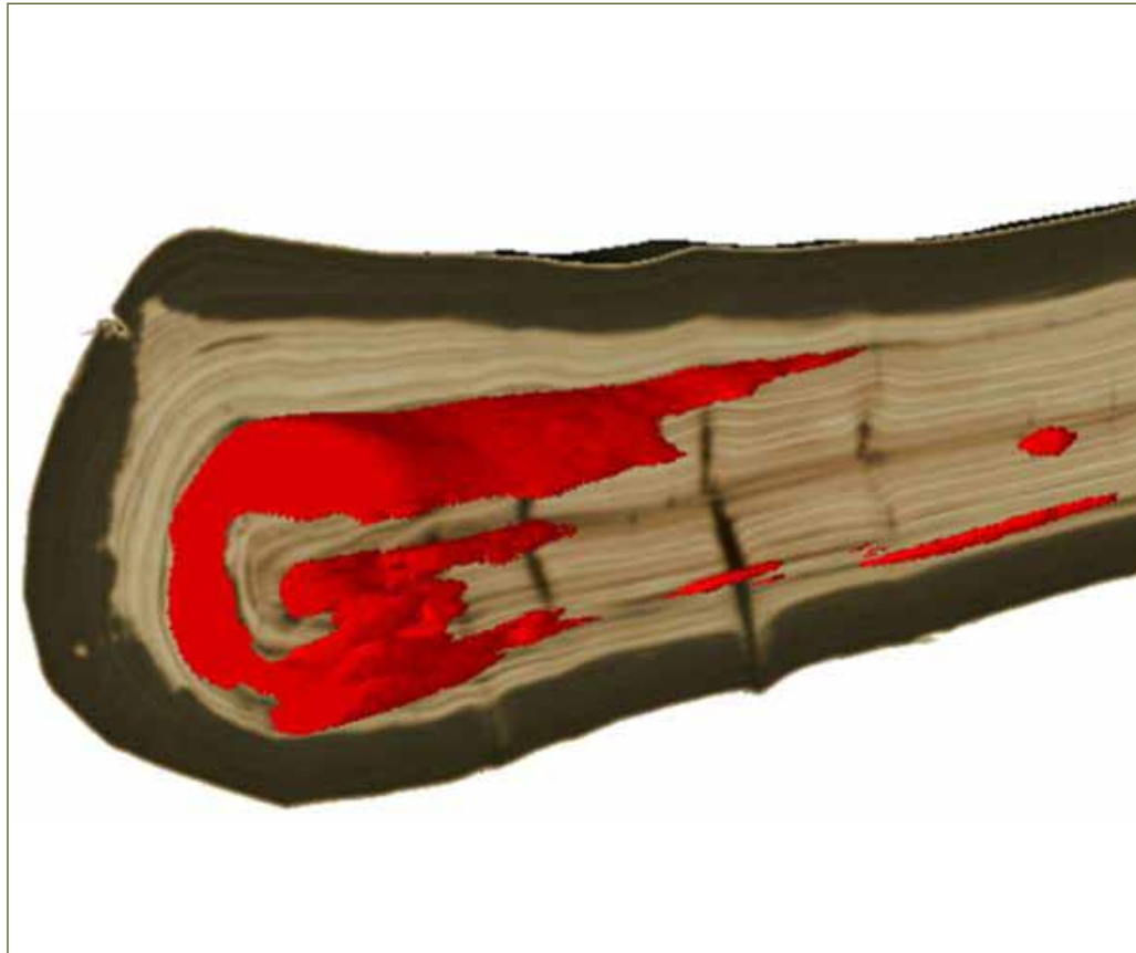
Abb. 4: Virtuell längs aufgeschnittener Stamm mit dunkel eingefärbtem Splintholz und rot eingefärbter automatisch erkannter Fäule
