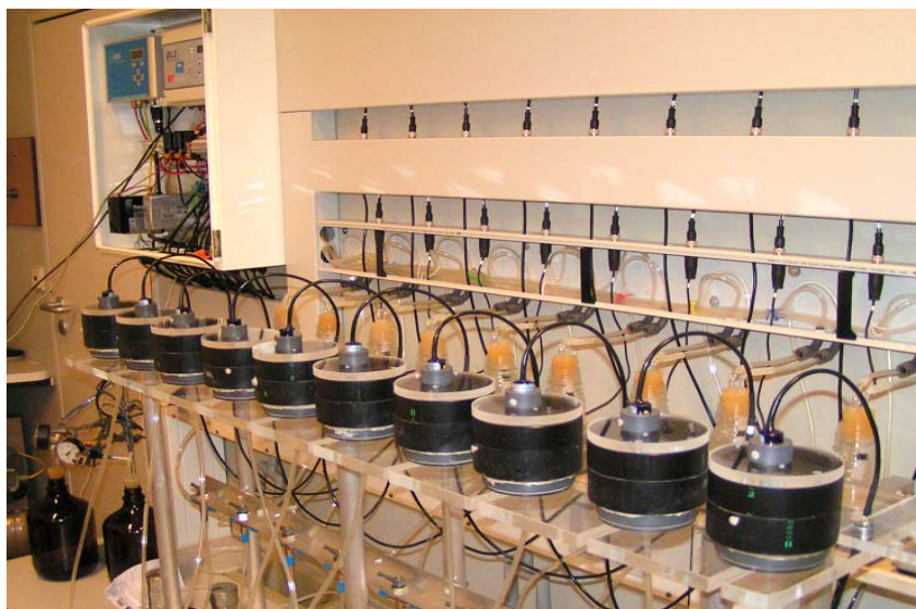
Abb. 1: Versuchsaufbau für Auslaufversuche zur Bestimmung der hydraulischen Bodeneigenschaften
