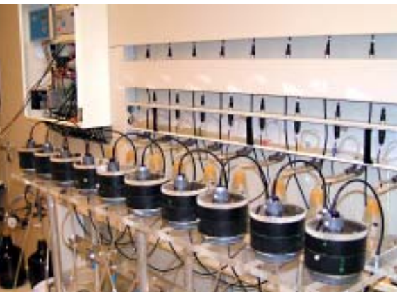
Abb. 6: Auslaufapparat zur simultanen Bestimmung der Retentions- und der ungesättigten Leitfähigkeitskurve an bis zu 10 Bodenproben
