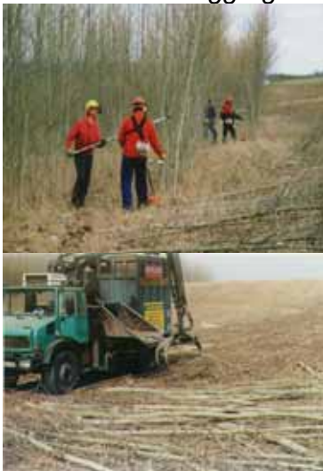
Abb.19: Motormanuelles Fällen u. Hacken mit forstüblichem Hackaggregat
