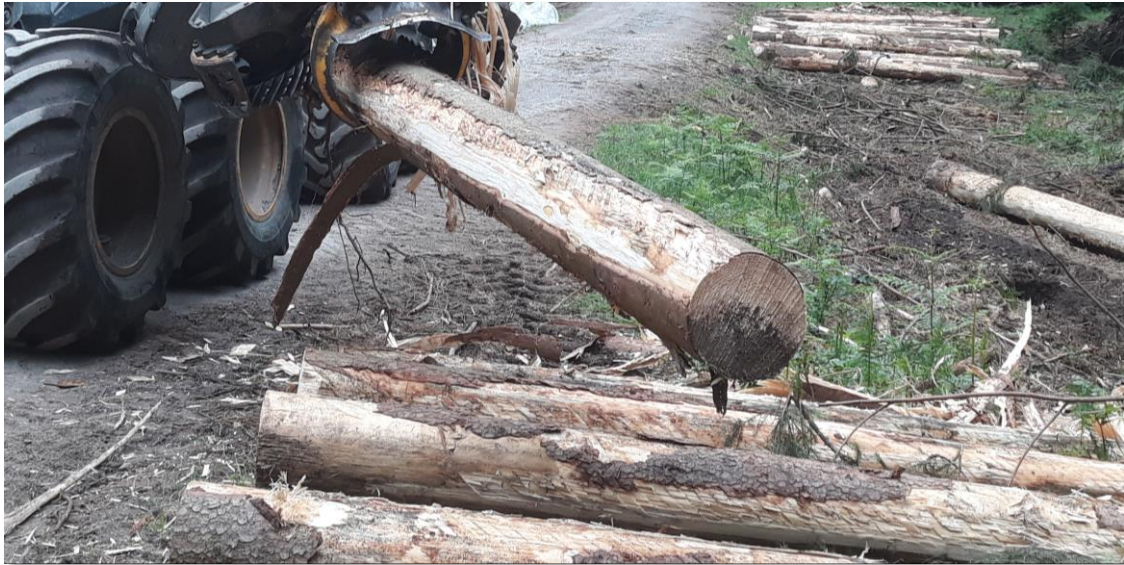
Abb. 3: Harvester-Aufarbeitung mit doppeltem, um 90° versetztem, Durchzug (wie im Foto zu sehen) ist generell wirksamer gegen Borkenkäfer als mit einfachem Durchzug, und bei braunen Entwicklungsstadien auch wirksamer als die Entrindung mittels Debarking-Head. Link zur FVA Waldschutz-INFO 03/2021 (Foto: FVA BW/Seitz)
