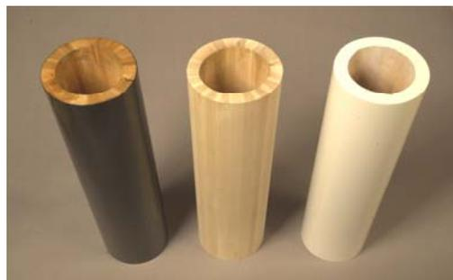
Abb.8: Rohrquerschnitte mit textiler Bewehrung, links Kohlefaser, Mitte unbewehrt, rechts Glasfaser, lackiert
