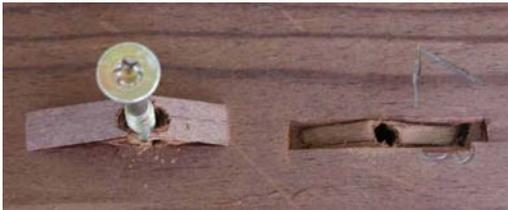
Abb. 2: Schraubenausziehversuche vorgebohrt (links) und nicht vorgebohrt (rechts)
