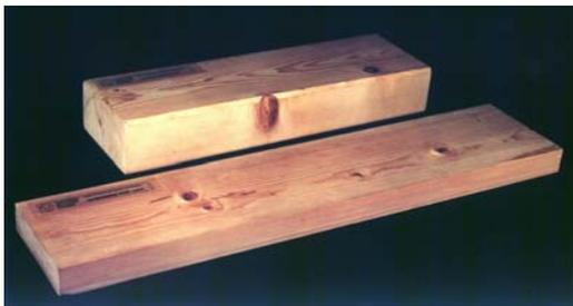
Abb. 1: Fichte-Kantholzquerschnitt vor und nach der Verdichtung
