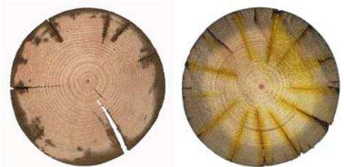
Abb. 2: Imprägniertes Nadelholz nicht vorbehandelt (links) und mit Bohrperforation (rechts) [3]
