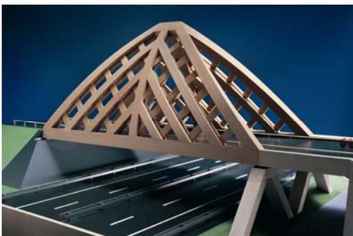
Abb. 3: Brücke in Sneek, NL, chemisch modifiziertes Holz ohne konstruktiven Holzschutz
