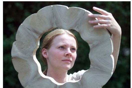
Abb.7: Ringförmiger Querschnitt aus verdichteten Halbrundhölzern
