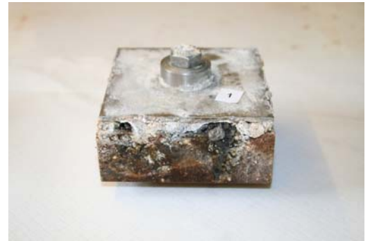
Abb. 1b: Prüfkörper eines Dauerhaftigkeitsversuchs nach der Beanspruchung
