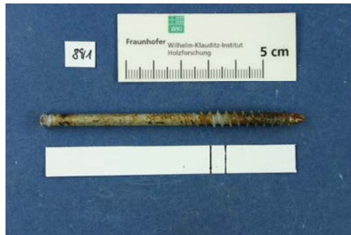
Abb. 3: Verbindungsmittel nach Korrosionsprüfung
