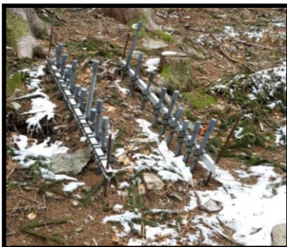
Abb 2. (links) Dauerinstallation zur Messung des Bodengasprofils an den Level II Flächen, (rechts) Entwicklung der abgeleiteten Methankonsumption am Standort Ochsenhausen.
