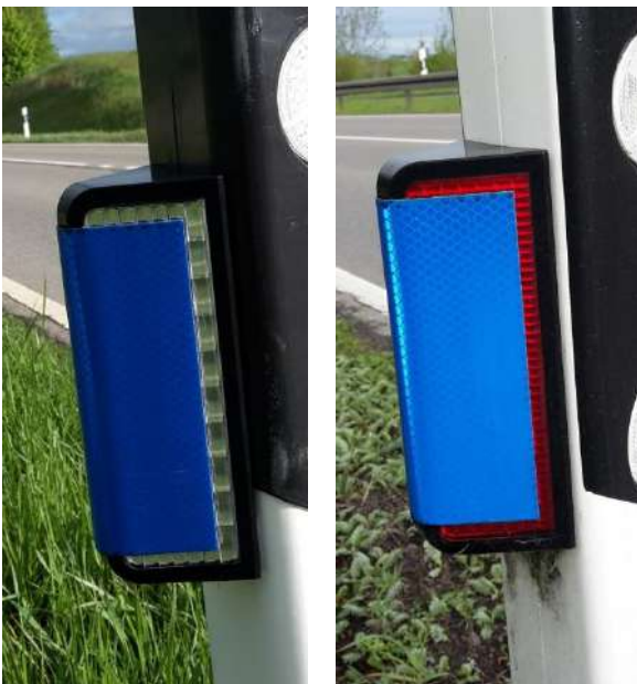
Abb. 14: Veränderter weißer WEGU-Wildwarnreflektor sowie veränderter roter Swarovski Wildwarnreflektor im Landkreis Balingen, L415.
