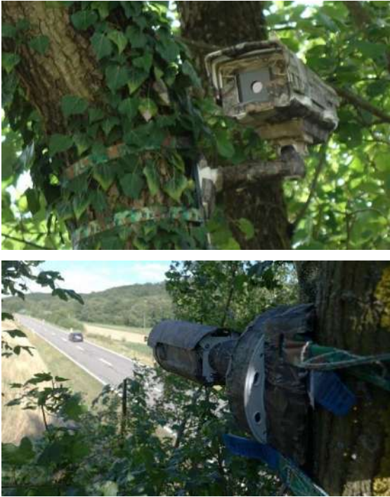
Abb. 20: Zwei Netzwerk-Wärmebildkammeramodelle der Firma Axis GmbH, die während der Untersuchung zum Einsatz kamen. Oben: Modell Q 1921-E, unten Modell Q 1941-E. Zum besseren Schutz gegen Diebstahl wurden die Kameras mit Camouflage Klebeband verblendet.
