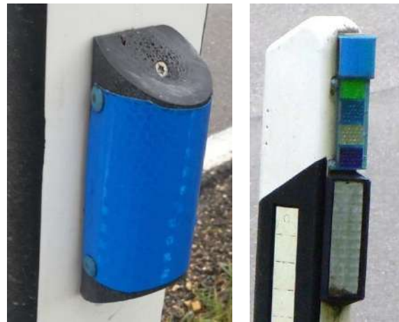
Abb. 15: Eigenbau im Landkreis Konstanz, L194 (li.) sowie zwei übereinander montierte Reflektoren (WEGU-Wildwarnreflektor und Motzener Multischutzwarner) im Kreis Ludwigsburg, K1643 (re.).
