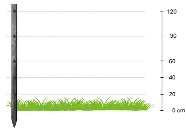
Abb. 1 | Eine Variante, den wolfsabweisenden Schutz umzusetzen, ist die halbmobile Zäunung nach empfohlenem Schutz mit stromführenden Leitern auf 20 – 40 – 60 – 90 – 120 cm und einer Mindestspannung von 4.000 V sowie einer angepassten Erdung.
