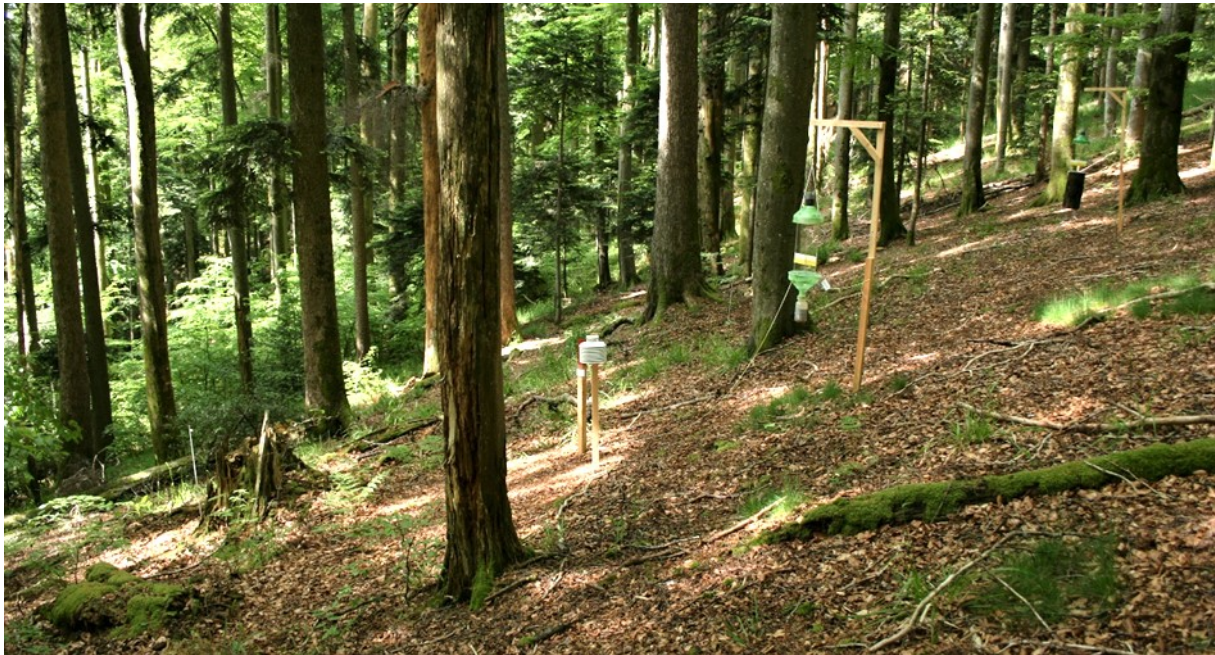
Abbildung 2. Das Zentrum einer 50 m × 50 m großen Probefläche. Zu sehen sind zwei Kreuzfensterfallen, Temperaturlogger und Markierungspfosten. Die Bodenfallen sind mit dünnen Stäben markiert und auf dem Bild kaum zu erkennen. Foto: B. Schwarz/ FVA-BW.
